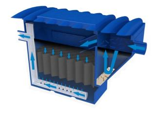
A caixa separadora deverá ser disposta em uma cava com um leito de no mínimo 20 cm de espessura confeccionado em areia e com profundidade tal, que a tampa da caixa fique abaixo do nível do piso, entre 30 e 70 cm. Verifique se a caixa separadora está totalmente apoiada sobre o leito e nivelada.
