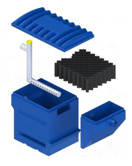
1 – Tampa do Reservatório – recipiente produzido em Polipropileno isento de aditivos, processado em sistema de rotomoldagem e ensaiado conforme ABNT NBR 14.605 -2:2010.
